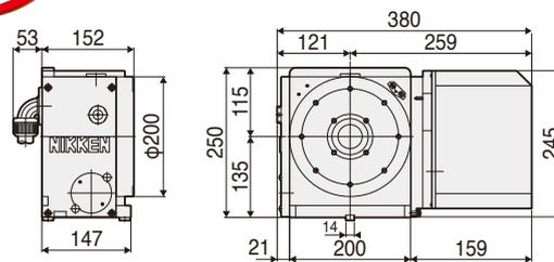
Powerful Clamping Torque : 900Nm
