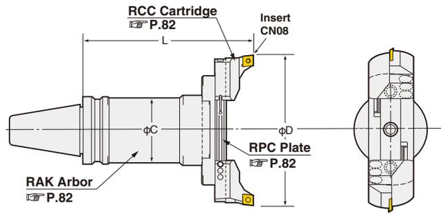
Boring Dia. :  $\phi 130 \sim 580\text{mm}$
