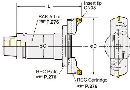
**Boring Dia.:  $\phi 130 \sim 580\text{mm}$**
