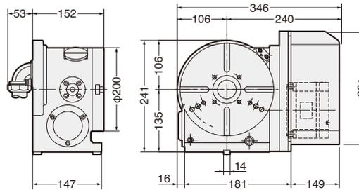
Powerful Clamping Torque : 303Nm
