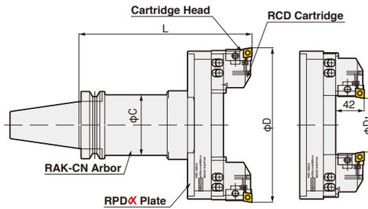
Boring Dia. :  $\phi 130 \sim 580 \text{mm}$  / Over Turning Dia. :  $10 \sim 430 \text{mm}$
