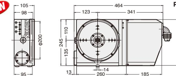
Powerful Clamping Torque : 380Nm
