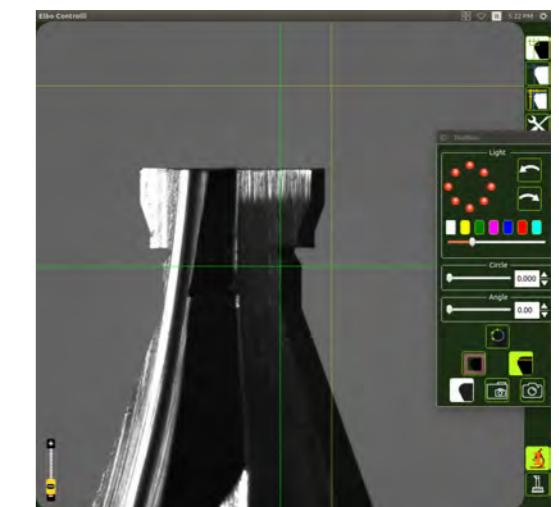
La seconda telecamera frontale permette un ingrandimento ottico X90, garantendo la visualizzazione di utensili con diametro molto piccolo.
