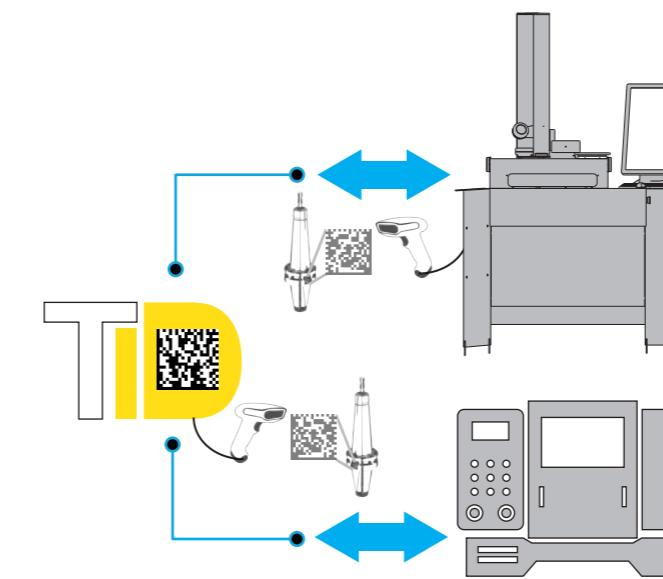
TID permette una comunicazione bidirezionale fra presetter e CNC. Le misure rilevate dal presetter vengono inviate direttamente al CNC senza fermo macchina.
