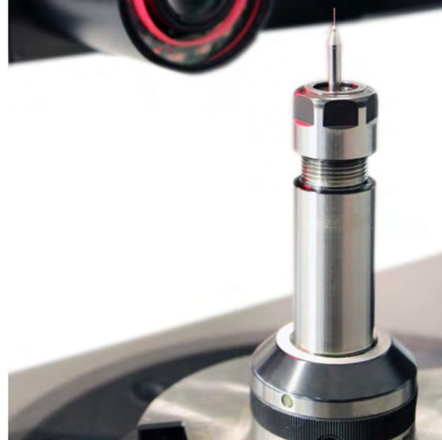
La seconda telecamera frontale permette un ingrandimento di circa 90 volte, garantendo la visualizzazione di utensili con diametro molto piccolo.
