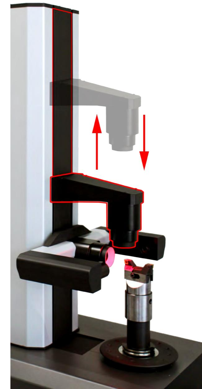
Una volta terminata l'operazione corrente con la telecamera verticale, un semplice clic sull'icona consente al preset di agganciarla e spostarla in posizione di partenza, permettendo all'operatore di riprendere in completa sicurezza le operazioni standard.
